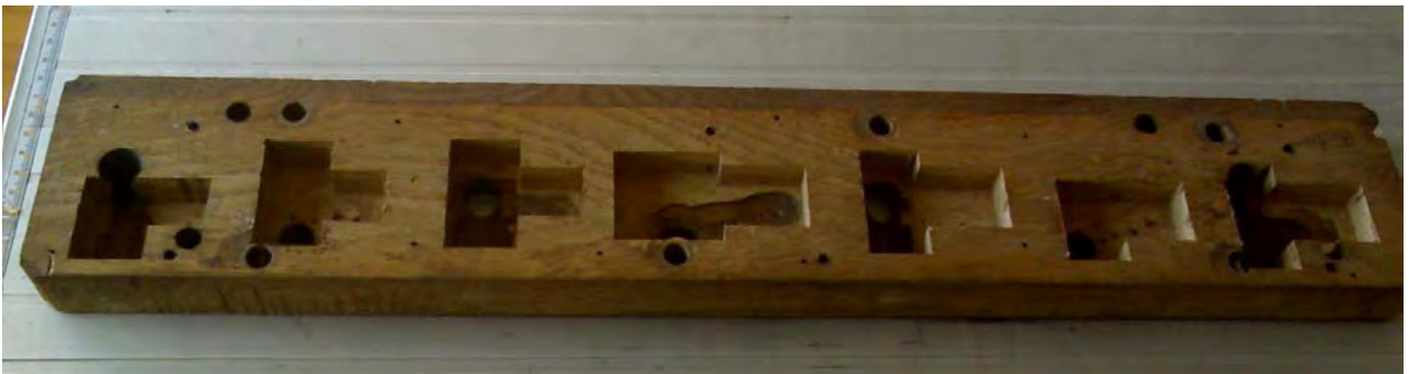
Abb. 080 – Mittelstock Lieblisch Gedackt 8', Vergrabungen ausgestemmt
