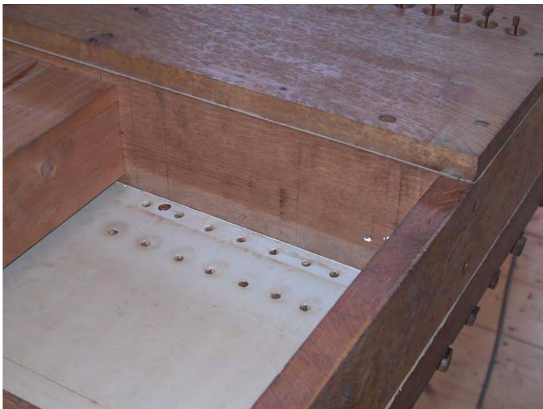
Abb. 034 angebohrte Kanzellenböden für Froschleiste (Juni 2007)
