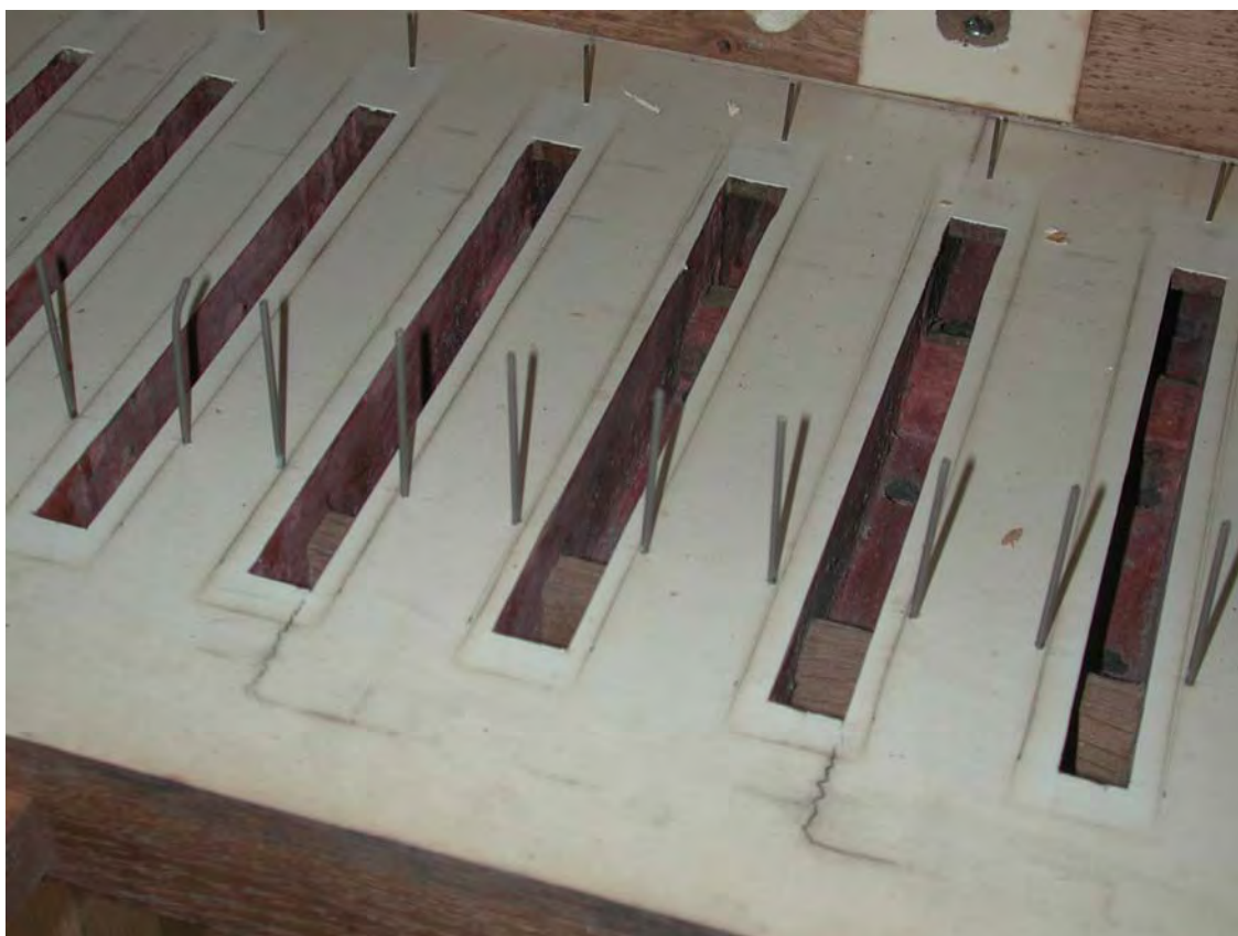
Abb. 035, 036 Kanzellenböden II Manual nach Ausbau der Ventile Juni 2007
