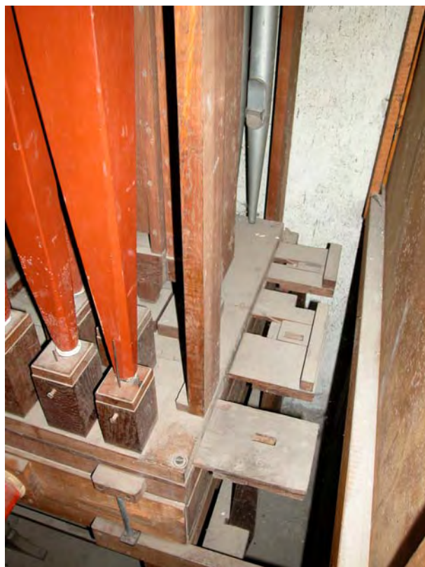
Abb. 019 (Dr. Hodick), 020, 021 + 022 (Dr. Hodick) Pedalpfeifenwerk und abgeräumte Pedallade Juli 2006
