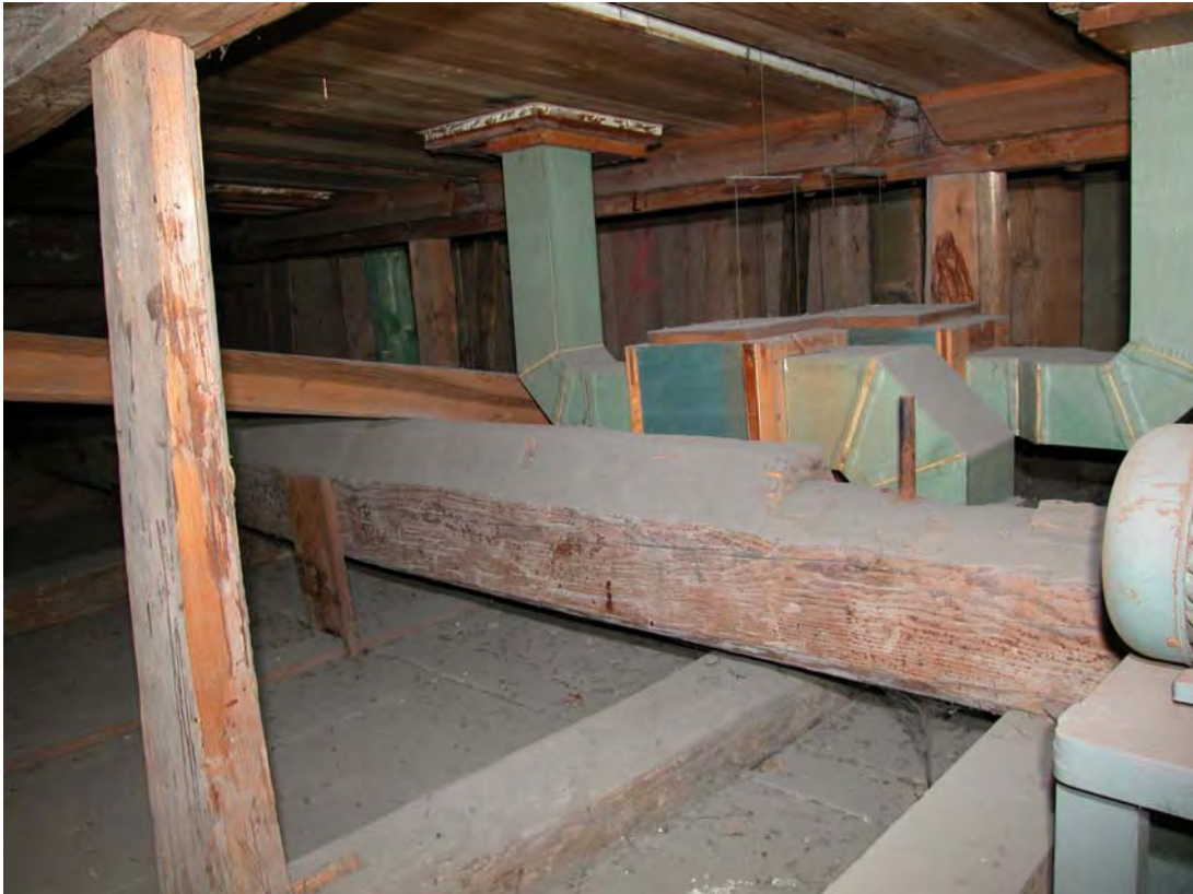
Abb. 026 (Dr. Hodick) Gebläseanschluss an zwei Keilbälge (Juli 2006)
