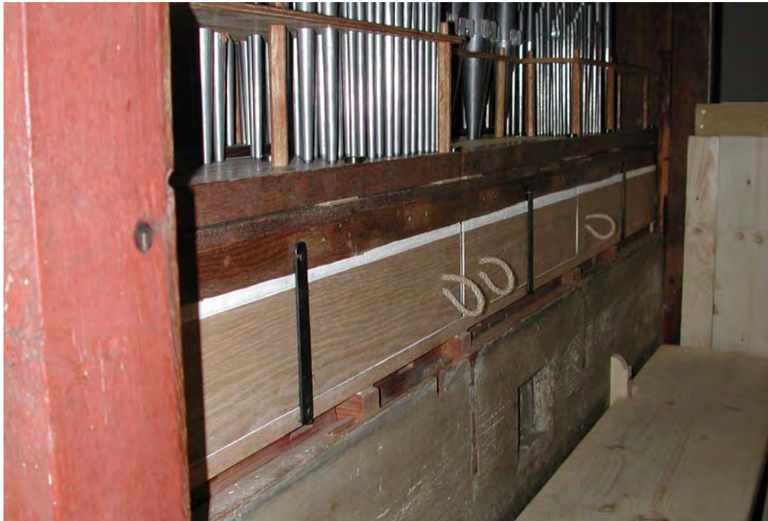
Abb. 055 Manuallade II Manual Ansicht mit neuen Spunddeckeln und Verschlüssen
