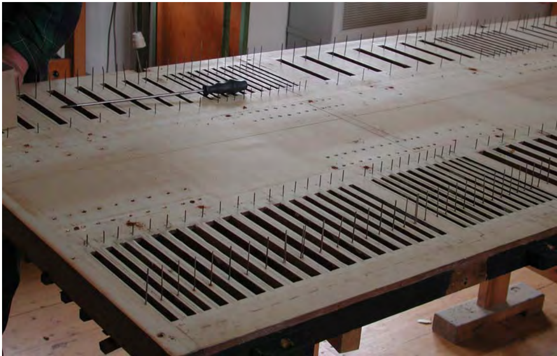
Abb. 037 Kanzellenrahmen nach Abnahme der Windkästen noch mit Papierung (Juni 2007)
