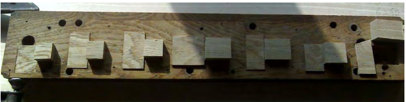
Abb. 080 – Mittelstock Lieblisch Gedackt 8', Vergrabungen mit Eiche ausgesetzt
