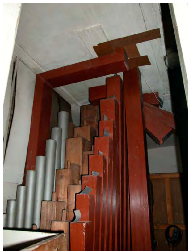
Abb. 019 (Dr. Hodick), 020, 021 + 022 (Dr. Hodick) Pedalpfeifenwerk und abgeräumte Pedallade Juli 2006
