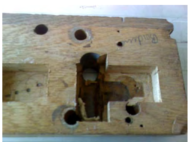
Abb. 080 – Mittelstock Lieblisch Gedackt 8', Vergrabungen mit Eiche ausgesetzt
