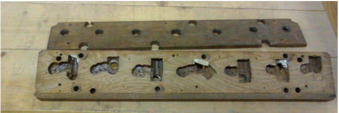
Abb. 079 – Mittelstock Lieblisch Gedackt 8', Dicke abgenommen
